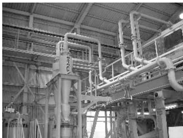
写真2 廃蛍光管破碎装置とサイクロン
