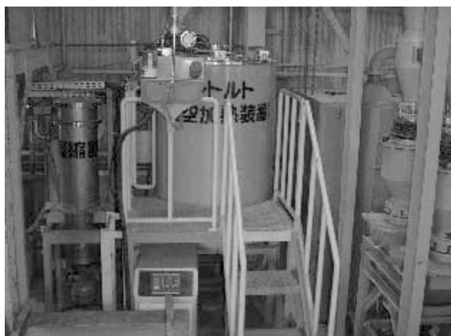
写真3 真空加熱装置
