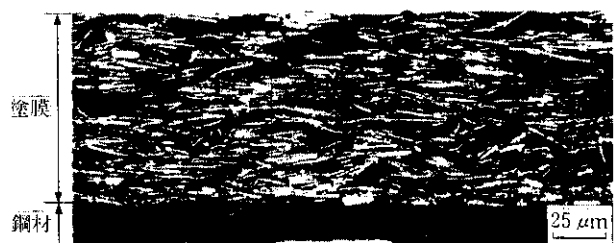
Photo 1 フェニックス塗膜断面
