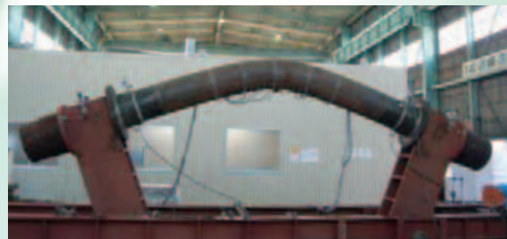
パイプライン用高強度材料の提案と大変形曲げ性能の実証試験
