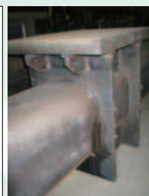
385級プレスコラムの曲げ実験・解析
