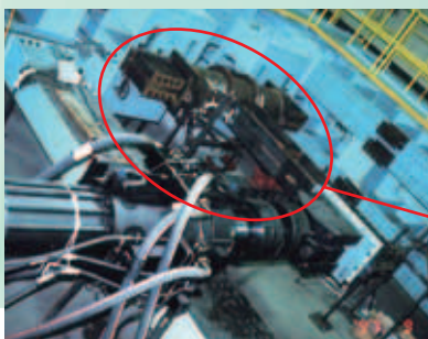
鋼構造物の部分架構試験体による柱梁接合部の耐震性能評価実験 (高速载荷試験機)
