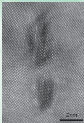
ナノハイチンの相界面析出の 高分解能電子顕微鏡像
