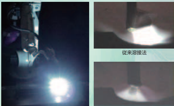
極低スパッタを実現した次世代CO 2 アーク溶接技術 「J-STAR溶接技術」
