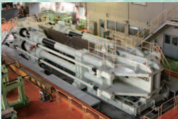
世界最大級の80MN構造物引張試験機
