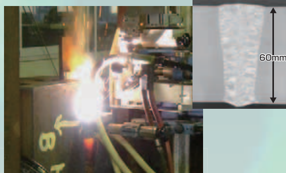
造船用厚板の大入熱1パスエレクトロガスアーク溶接 (板厚60mm、溶接入熱：45kJ/mm)
