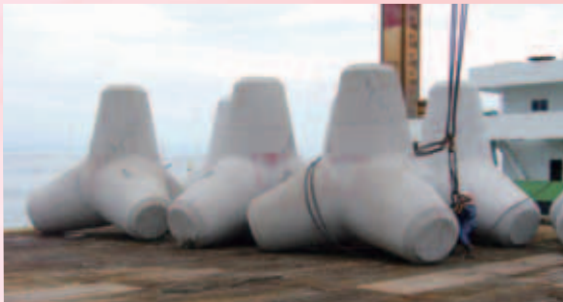
消波ブロックとして利用している水和固化体「フェロフォーム®」
