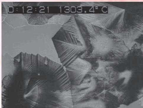
高温レーザー顕微鏡による モールドフラックス凝固現象直接観察結果
