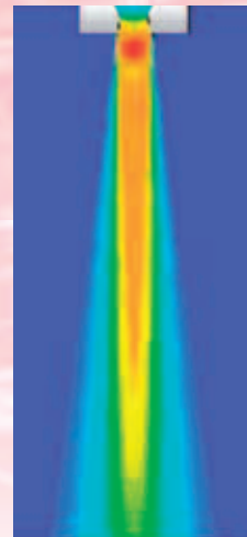
転炉ランスノズルからの 超音速酸素噴流の流速解析例
