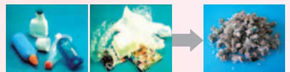
使用済みプラスチックの高炉原料化
