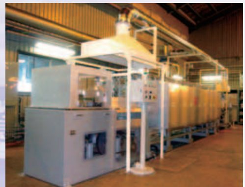
実機仕上還元条件を再現できる熱処理炉
