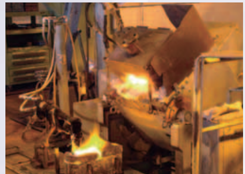
各種合金鋼粉を製造可能な水アトマイズ設備
