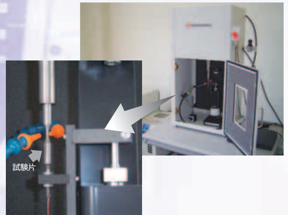
超音波疲労試験機による軸受鋼の疲労寿命評価
