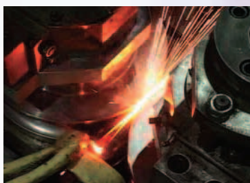
継目無鋼管の穿孔実験 (油井・パイプライン用)
