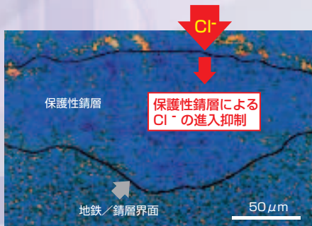
耐候性鋼鍍層断面の EPMA 写真
