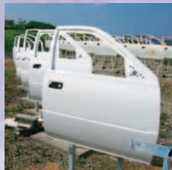
実車ドア部品の暴露試験 (沖縄)
