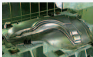
実プレス型によるフェンダパネル成形
