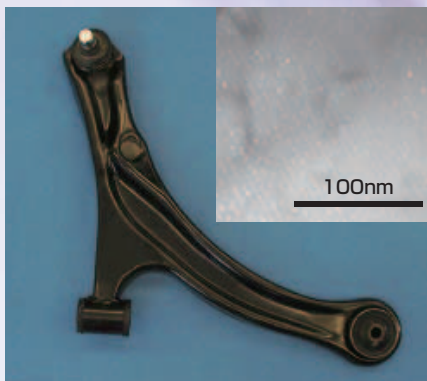
780MPa級NANOハイテンを用いて成形したサスペンションアームと微細炭化物のTEM像
