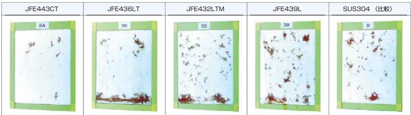
沖縄大気暴露試験 4年間 (表面#600研磨仕上げ)
