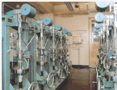
▲硫化物応力腐食われ試験装置
