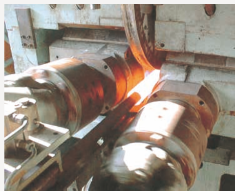
▲シームレス鋼管穿孔圧延用実験ミル
