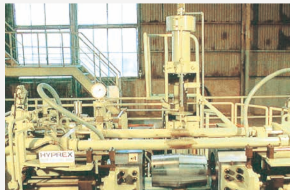
▲ハイドロフォーミング試験装置 (内圧:2,000気圧)
