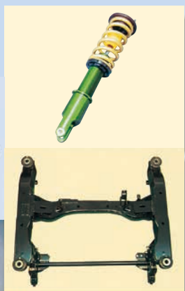
▼機械構造用 上/ショックアブソーバー 下/サスペンションメンバー
