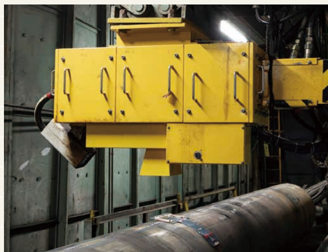
中央部X線透過検査設備
