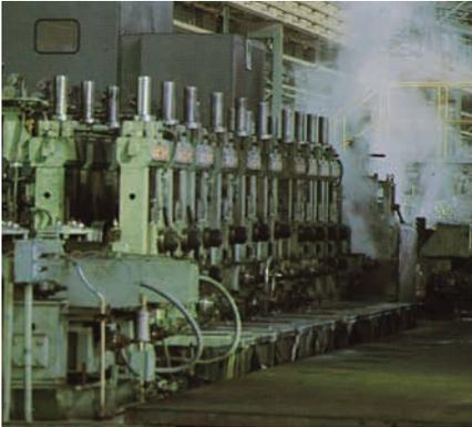
小径の電縫管工場では広幅コイルを管外径に合った所定の寸法にスリットし、コイル端溶接機でコイル端を溶接後、エンドレスに成形機に装入します。成形機で管状に成形されたコイルは自動ヒートコントロールシステムを取り込んだ高周波誘導溶接機で溶接され、同時に内外面のビードを除去し必要に応じてポストアニーラにより溶接部の熱処理が施されます。その後、定径機により最終製品寸法に仕上げられ走行切断機で定尺切断、矯正機により曲がり除去の後、精整、検査工程を経て製品として出荷されます。検査工程では全数渦電流探傷及び外観寸法検査が施されるほかに、必要に応じて超音波探傷により検査を行います。
