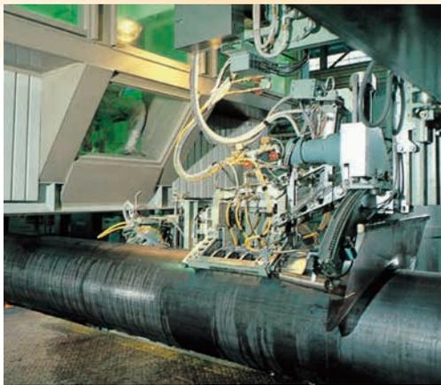
■渦電流探傷機 (知多製造所：6"電縫管工場の例)
