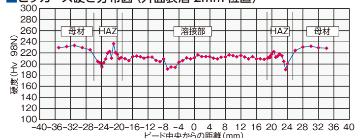
■ビッカース硬さ分布図 (外面表層 2mm 位置)
