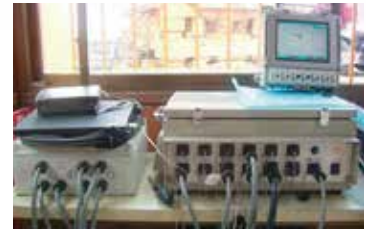
施工管理計の例
