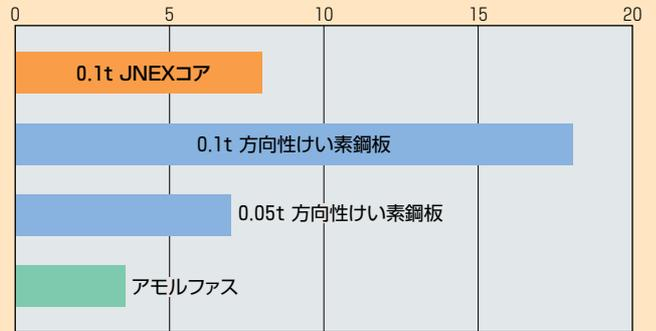
■カットコア (CS500) の鉄損 W1/10k(W/kg) (当社測定データ)
