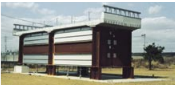
Type1 鋼の試験橋 15mW × 4mL × 3mH 三重県津市に3年暴露 (年間平均飛来塩分量: 0.3mdd)
