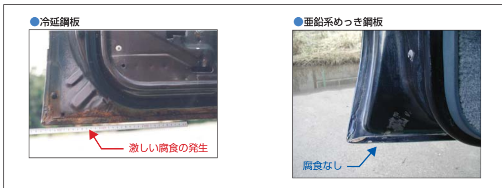
北米8年走行車 ドアヘム部の腐食状況
