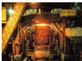
取鍋精錬設備
