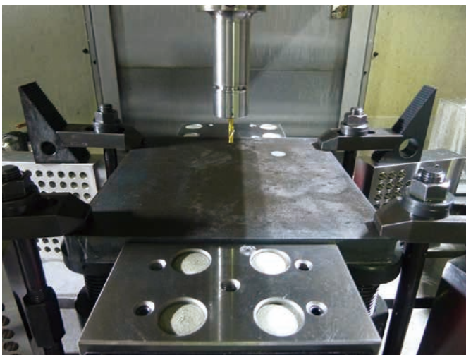
鋼板(被削材)の固定の例
