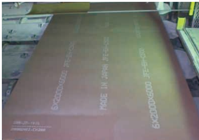
プライマー処理された標準エバーハード厚鋼板（EVERHARD-C500（JFE-EH-C500））の典型的な外観例
