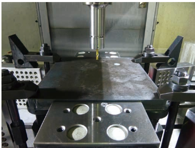
Ejemplos de fijación de la placa de acero (materiales de trabajo)
