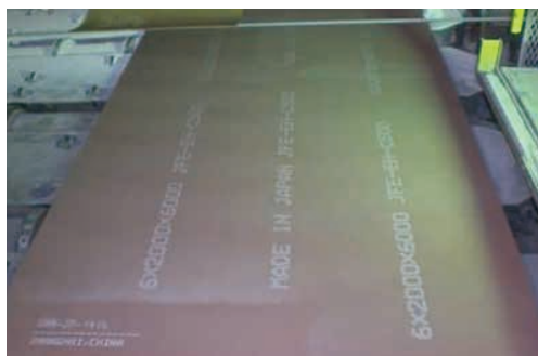
Ejemplo de apariencia típica de placa de acero estándar de EVERHARD (EVERHARD-C500(JFE-EH-C500)) procesado con tratamiento de imprimación.
