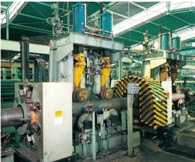
▲ *Inspeção eletromagnética*
