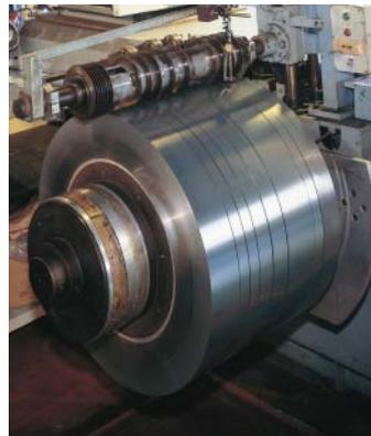
\*Der Grundbund wird abgewickelt in einer Längsteilanlage längsgeteilt und dann wieder aufgewickelt.
