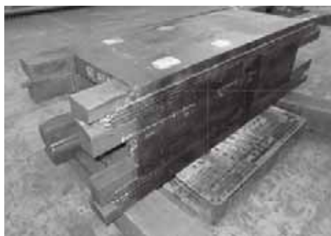
写真1 HBL ® 630 を用いたボックス柱サンプル
