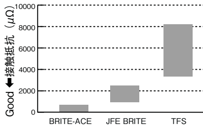
図2 『BRITE-ACE ® 』と他材料の接触抵抗の比較
