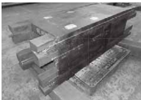
写真1 HBL ® 630 を用いたボックス柱サンプル
