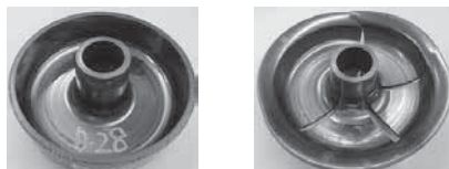
写真1 (a) J48Cおよび (b) S35Cによるロータホルダ模擬部品 (外径：110.6mm, 高さ43.8mm) 試作結果 (試作：株式会社ニチダイ)
