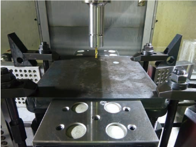
钢板（被加工材料）的固定示例
