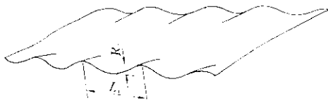
図5 板の形状(耳伸びの例)
