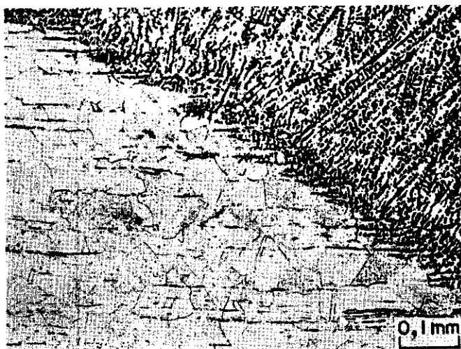
写真 2 SUS-27 の溶接部の組織
